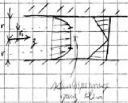
Aus dem Impulssatz (z-Komponent) ergibt die Schubspannungsverteilung:
